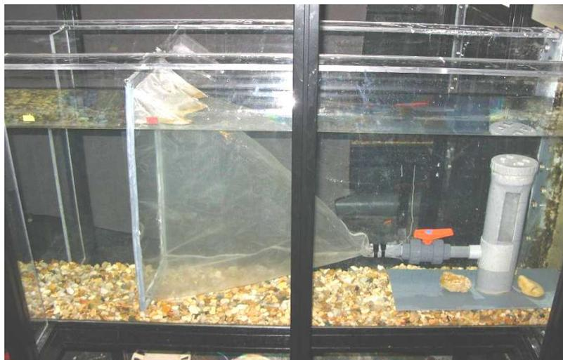
**Figure 21: Piège à larves en place, filet et collecteur (photo Ph. Jatteau, Cemagref)**
