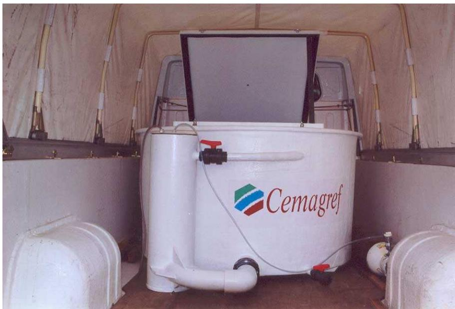
Figure 4: Cuve de transport de géniteurs d'aloses (Photo Ph. Jatteau, Cemagref)
